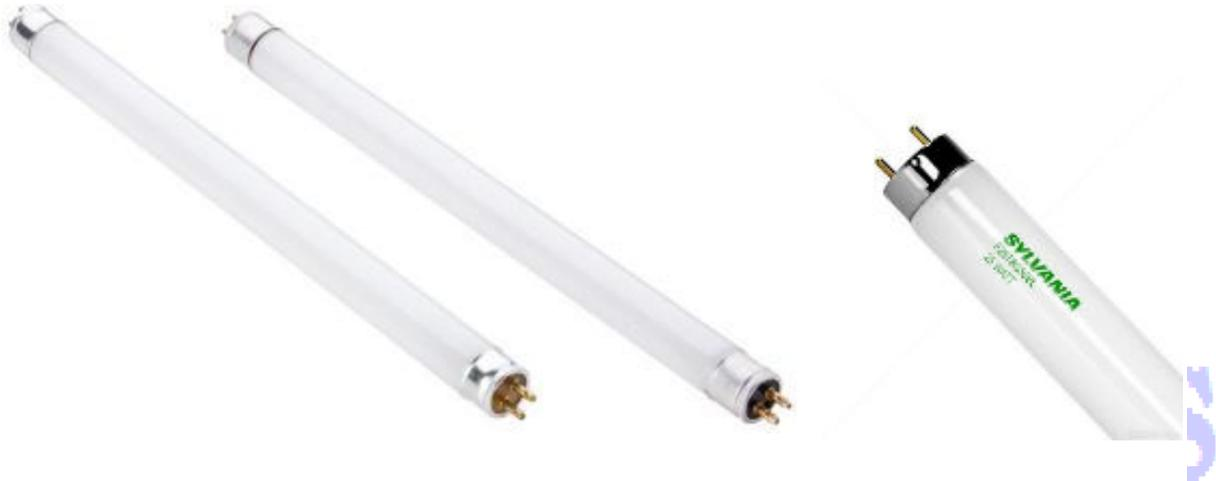
Los tubos especiales de luz ultravioleta que se emplean para el control de insectos voladores tienen una recubierta interior de sales de fósforo que, cuando se enciende el tubo, emiten luz ultravioleta. Esta capa se pierde virtualmente al cabo de un año de uso y cuando ocurre esto la cantidad de luz ultravioleta que se emite es insuficiente para atraer a las moscas. Los tubos, sin embargo, continuarán funcionando, simplemente emitiendo luz visible.
